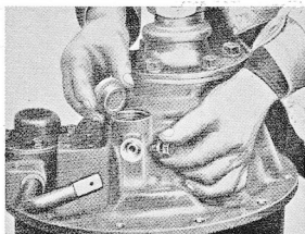
Dépose de la cuillère de récupération d'huile.
